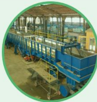
Canal experimental de socavación en pilas
